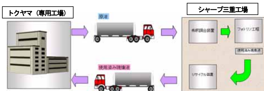
「シャープ三重工場における現像液のクローズド・システム」
