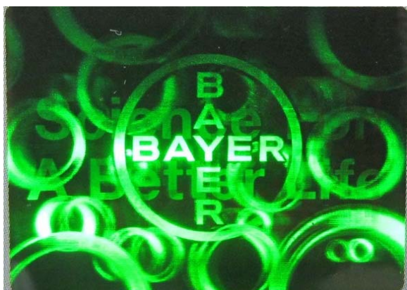
バイエルのホログラム用フィルムバイフォール®HXに記録したホログラム
