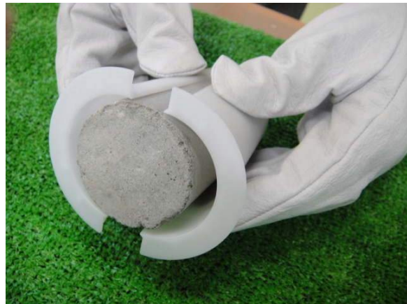
脱型は手で半分に割って供試体を採取する
