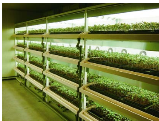
人工光・閉鎖型苗生産装置「苗テラス」
