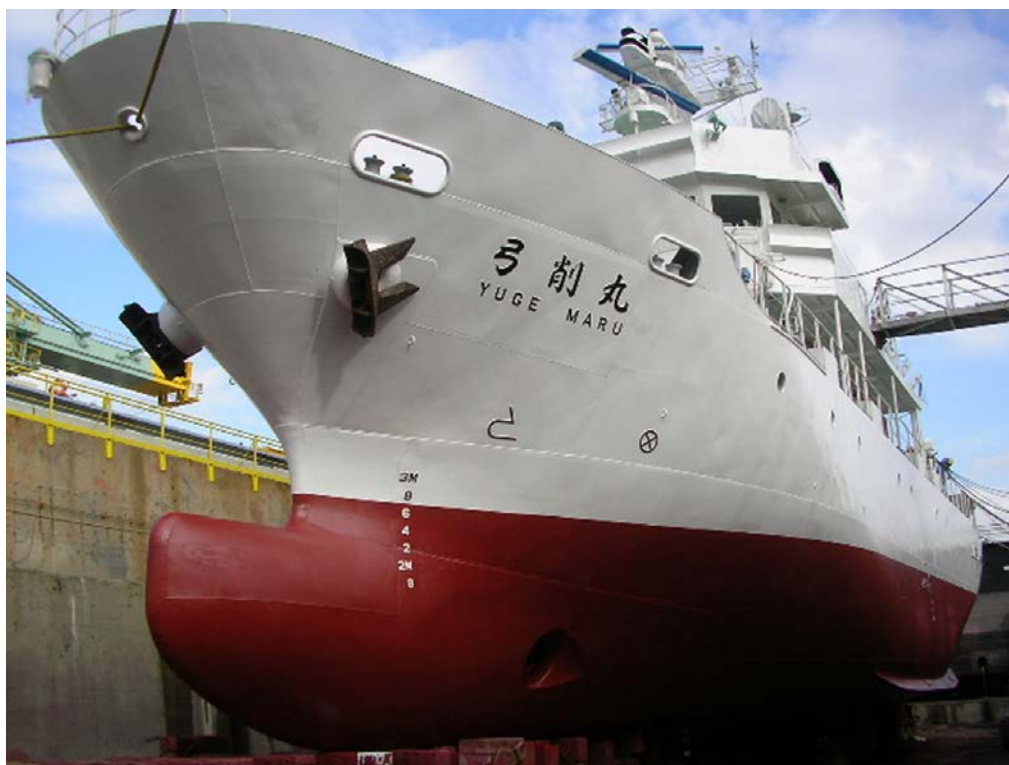
新規船舶防汚塗料が使用されている国立弓削商船高等専門学校の実船
