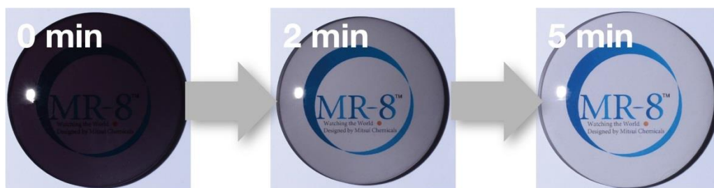
SunSensors™ MR-8™ レンズの色の变化のイメージ（屋外で発色後、屋内で時間と共に退色していく様子）
