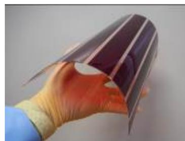
写真3. 「曲がる」太陽電池モジュール
