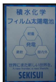
裏面に貼り付けたフィルムタイプ DSC で発電した電力で青と白を反転表示しアイキャッチ 写真1. 電子看板(A1サイズ)
