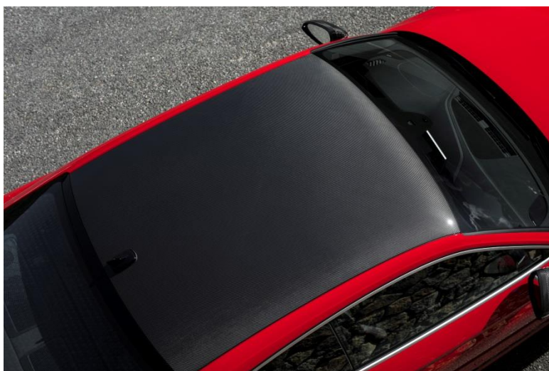
【当社の CFRP が採用された「Audi RS 5 Coupé」のルーフ、オプション仕様】
