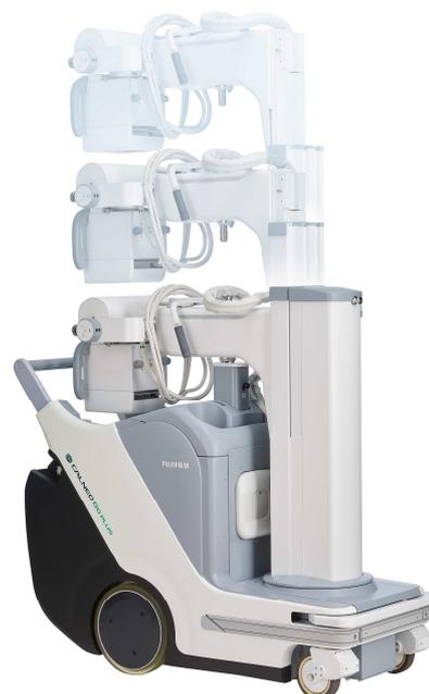
支柱が収納できるため、進行方向の視野が確保しやすい。
