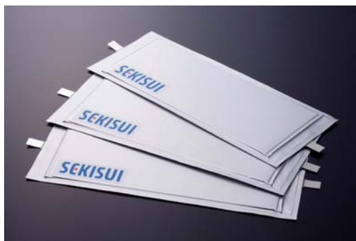
写真. 当社のフィルム型リチウムイオン単電池 (サイズ:長さ510mm×幅209mm×厚さ5.1mm以下)
