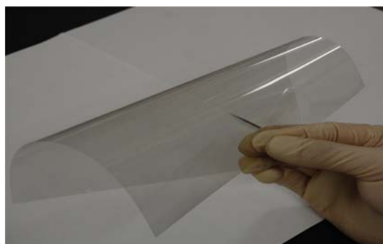
CNT 分散液を塗布した透明導電フィルム
