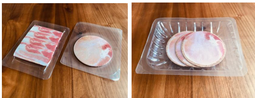
〈PLANTIC〉をバリア層に用いた環境対応型包装
