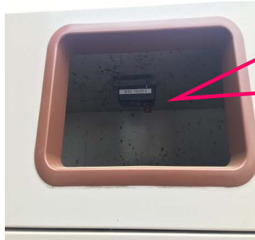
(ゴミ容器内に設置した Smart LEVEL)
