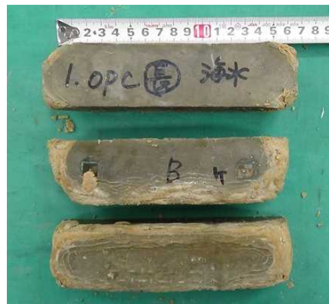
左：写真1 深海底での試験体の暴露試験（写真は JAMSTEC からの提供）
