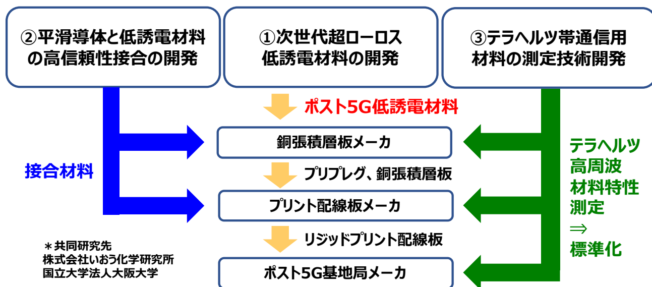
【図1: ミリ波・テラヘルツ帯向け高機能材料・測定の研究開発概要】
