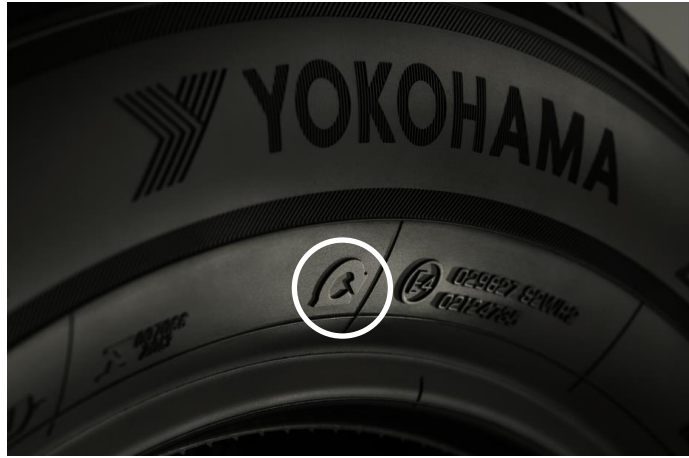
BluEarth-XT AE61 Z・P・S に刻印されている EMT 規格のマーク
