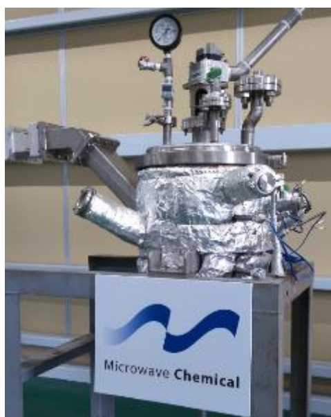
検証を行うマイクロ波小型実証設備
