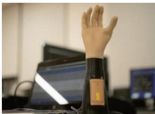
腕の筋肉から発生するわずかな電流に反応し、 自分の意思で手指を動かすことができる筋電義手
