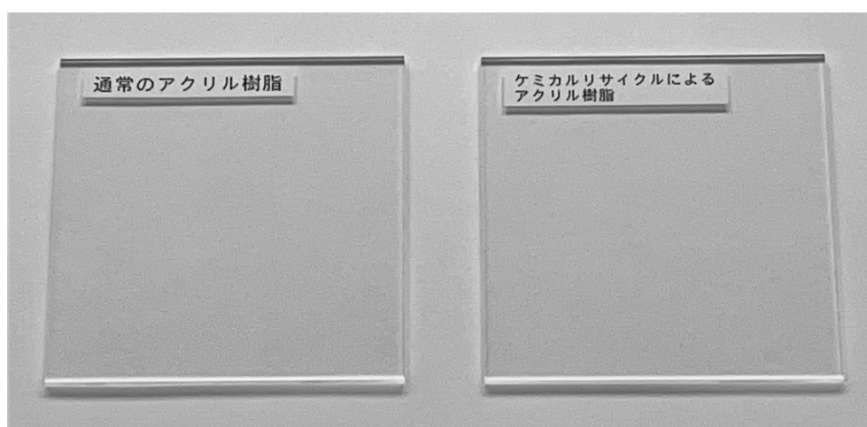
通常のアクリル樹脂（左）と再生した MMA モノマーを用いたアクリル樹脂（右）
