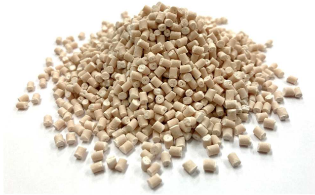
天然素材の卵殻を配合したサステナブルプラスチック「PLATIECO®」
