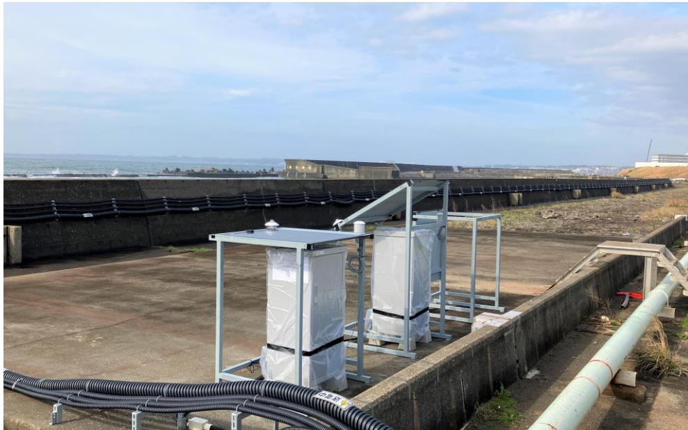
フィルム型ペロブスカイト太陽電池設置写真 横須賀火力発電所
