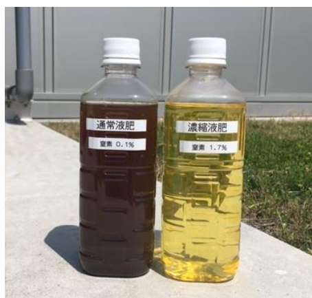
（左）通常液肥（右）濃縮バイオ液肥 濃縮バイオ液肥は懸濁物質の除去で透明度が増し、 さらに電気透析で肥料成分が濃縮されている
