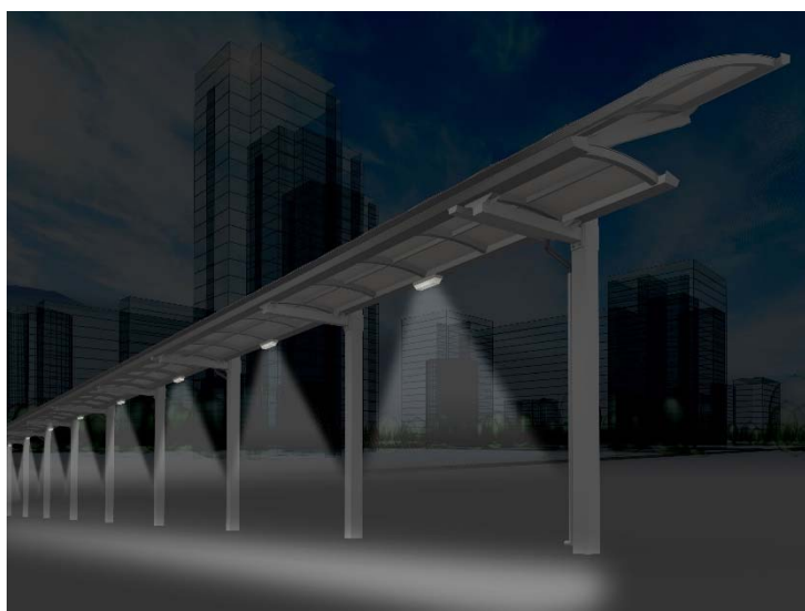
蓄電池に電力を貯め夜間のLED照明点灯に活用
