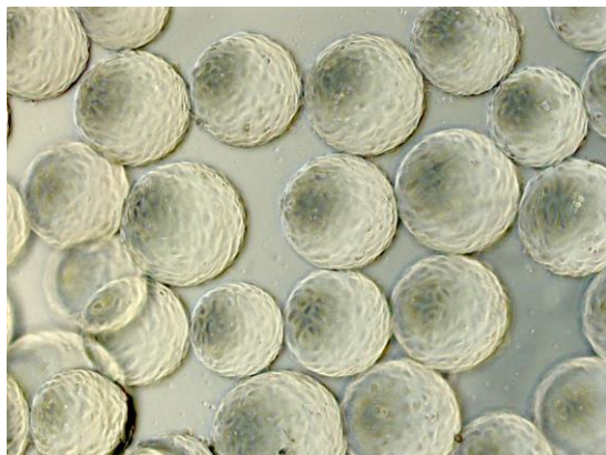
PVA ハイドロゲルマイクロキャリア上の培養細胞の顕微鏡画像
