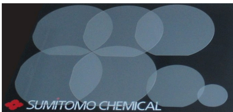
GaN基板 右から2インチ(量産)、4インチ(量産)、6インチ×5枚(開発中) (※)
