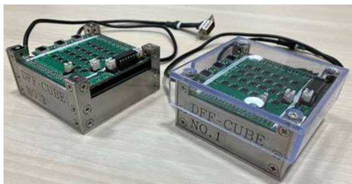
評価用の半導体チップを搭載した動作評価装置
