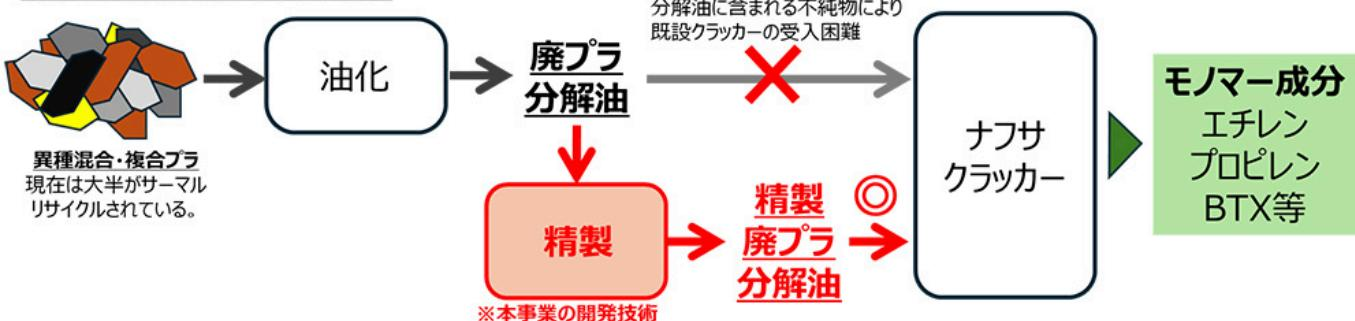
三井化学では、カーボンニュートラルに貢献するバイオマス由来の「BePLAYER」と、リサイクルによるサーキュラーエコノミーに貢献する「RePLAYER」という2つのブランドを展開し、再生可能資源の活用と資源循環を推進しています。大阪工場にあるクラッカーでは、2021年12月よりバイオマスナフサの投入を開始し、2024年3月からは廃プラ分解油の投入も開始。マスバランス方式に基づく製品生産を進めています。バイオナフサ活用と廃プラ分解油によるケミカルリサイクルの両輪で、石化原料からの原料転換を進め、日本初のバイオ&サーキュラークラッckerを実現し、サステナブル（持続可能性）を超えたリジエネラティブ（再生的）社会の実現に貢献してまいります。
