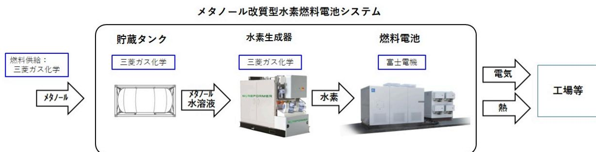
国内で一般的に流通している圧縮水素（20 MPa）と比較して、メタノールは同じ物流体積当たり約6倍量の水素分子を貯蔵・輸送できます（摂氏25度で計算）。
