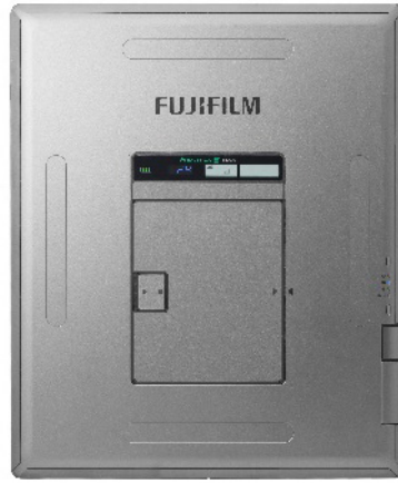
低線量でも高画質な画像を得られるFPD(X線画像平面検出器)
