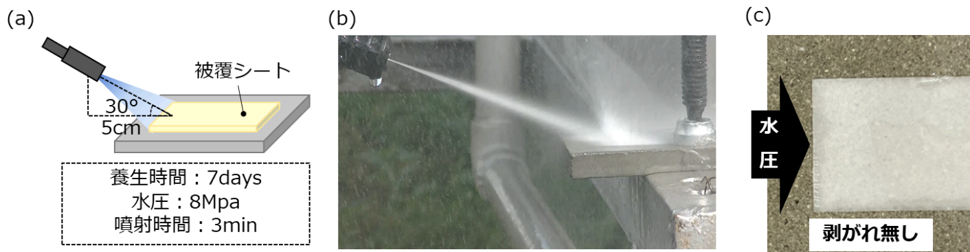
図3：(a)耐剥がれ試験方法、(b)実際の試験の様子、(c)試験後画像
