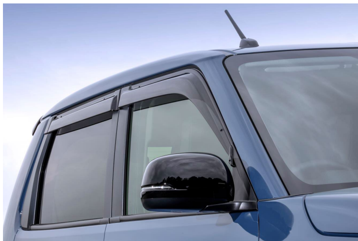
アクリル樹脂リサイクル材を使用した N-ONE e:用「ドアバイザー」
