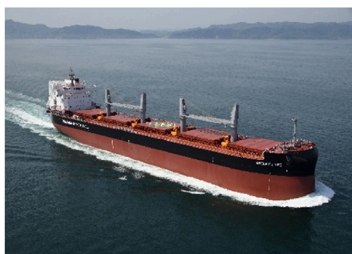
メタノール二元燃料ばら積み船「Green Future」 (写真提供：NYKバルク・プロジェクト)
