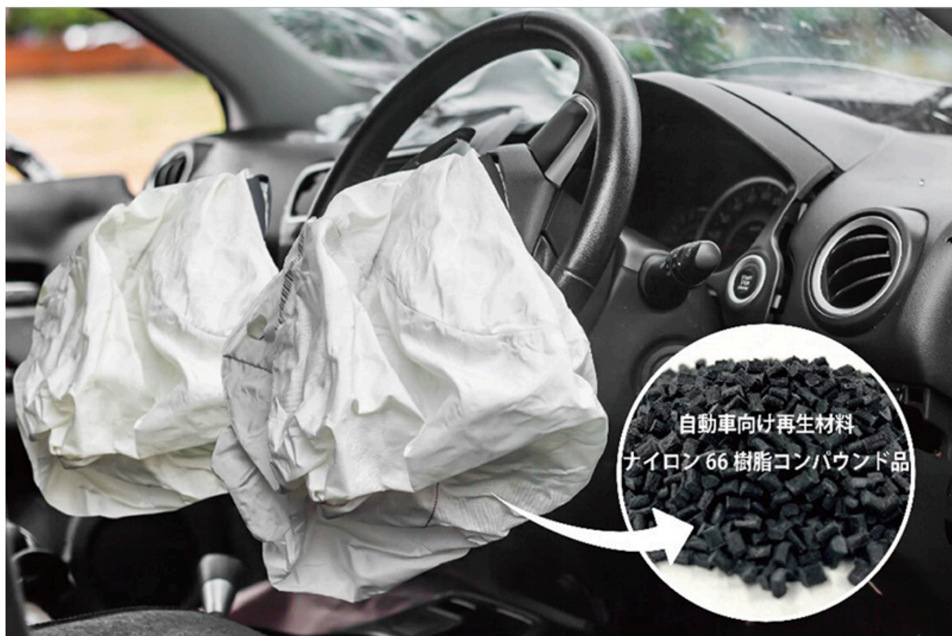
【廃車エアバッグからリサイクルしたナイロン66樹脂（コンパウンド品）】
