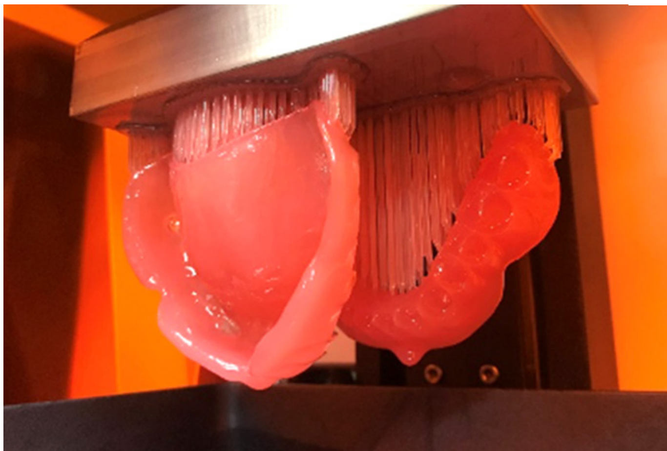
3Dプリンターによる義歯床部分の作製
