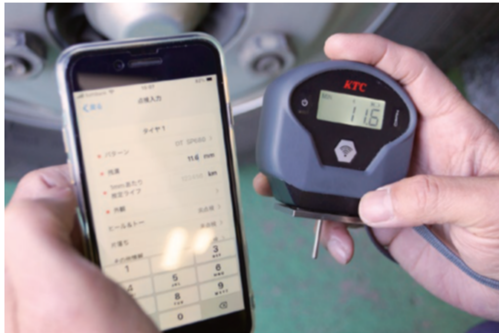
デジタルデプサと接続し、タイヤ残溝を自動入力可能に
