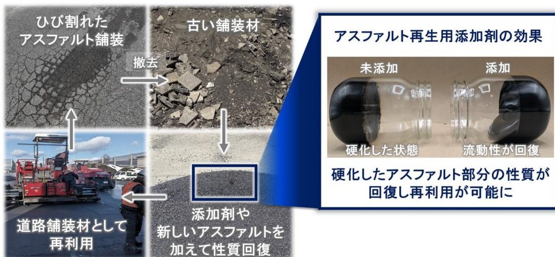
図 1. アスファルト舗装の循環利用とアスファルト再生用添加剤の効果
