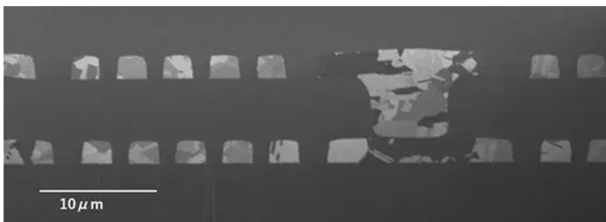
感光性ポリイミドフィルムと「サンフォート™ TAシリーズ」による再配線層断面図
