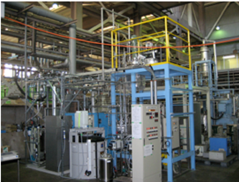
高濃度硝酸分解技術の検証に用いた工学規模試験装置
