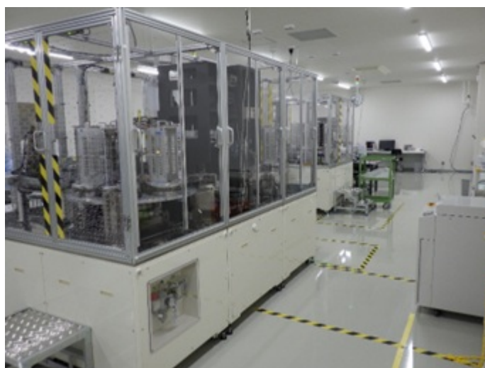
ファラデーローテータの光学特性を検査するグラノプト第2工場内の装置
