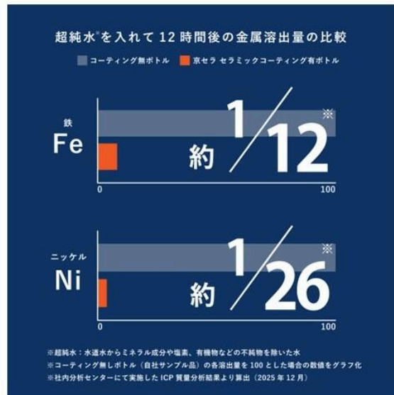
純水を入れて12時間後の金属溶出量を比較 ※加工無しボトル(自社サンプル品)の各溶出量を100とした場合の数値をグラフ化 ※社内分析センターにて実施したICP質量分析結果より算出(2025年12月)
