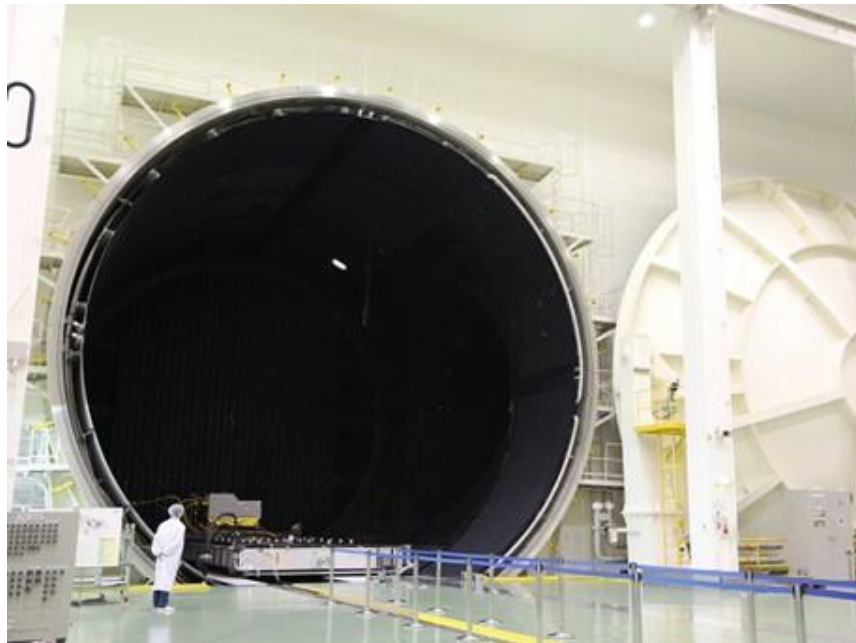
既設の直径13mのスペースチャンバ(JAXA提供)
