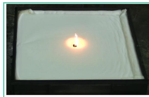
耐火試験(5分間): 燃焼範囲の拡大なし ■『エルシコール® A77』を用いた耐火試験
